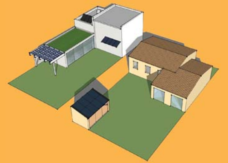
Panneaux implantés sur annexes, en brise-soleil
